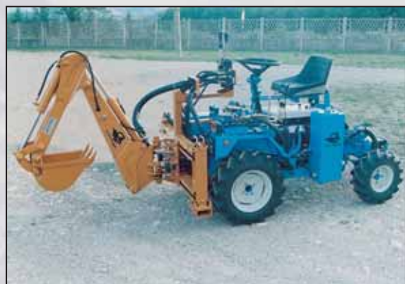
ESCAVATORE MASTER: profondità di lavoro m. 1,50 - angolo rotazione braccio 180° con due martinetti - distributore a 2 cloches + 2 leve per azionamento dei 2 piedi di appoggio indipendenti.
